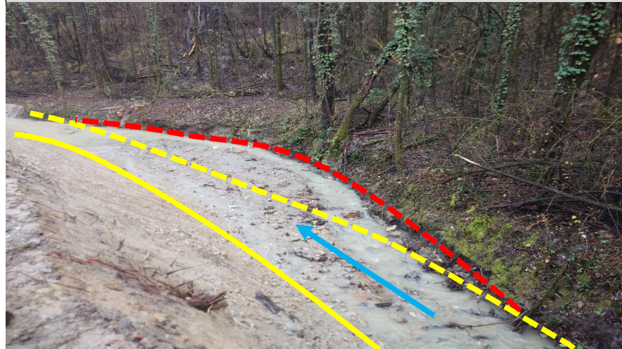
Unità morfologiche rilevate il 12/12/2014. In giallo continuo la sponda sinistra, in giallo tratteggiato la sponda destra pre intervento, in rosso la sponda destra arretrata
